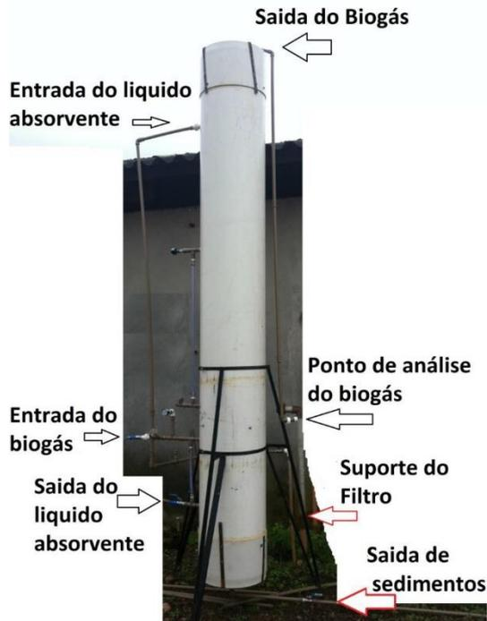
Figura 6 – Identificação dos componentes do Filtro
