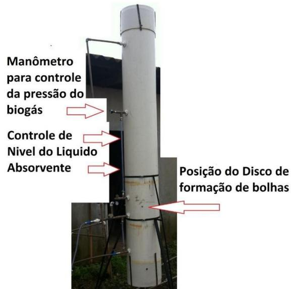
Figura 7 - Posição do manômetro na câmara de reação química; Posição da mangueira para controle de nível do líquido; Posição do disco interno formador de bolhas
